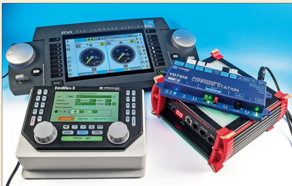
Etliche Digitalhersteller unterstützen den Multiprotokoll-Betrieb am Gleis und bieten zahlreiche Anschlussmöglichkeiten für Bussysteme sowie Unterstützung für mitunter gleich mehrere Netzwerkprotokolle.
